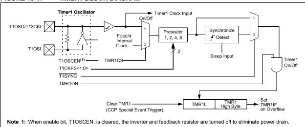
TIMER1 BLOCK DIAGRAM (16-BIT READ/WRITE MODE)
